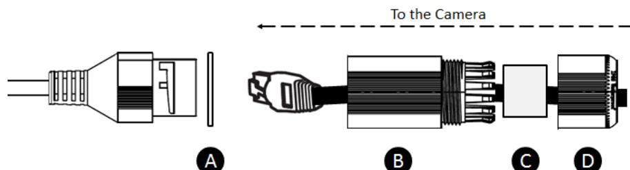
(2) RJ45 防水コネクタを接続したネットワークケーブルをカメラに挿入します。
