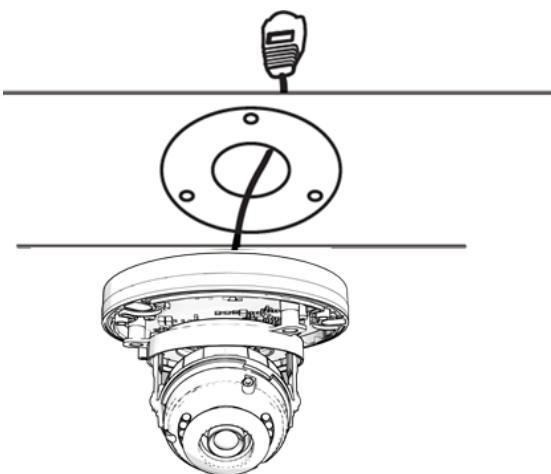
(3) 付属のドライバーを使用し、ドームカバーを外し、
